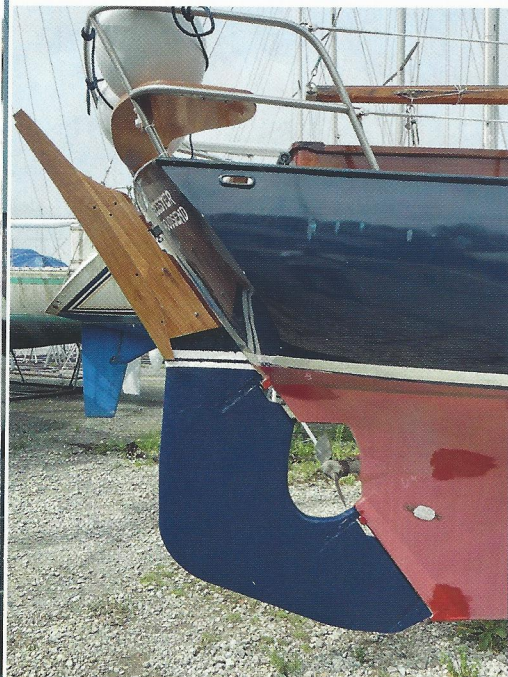
Het nieuwe roerblad geïnstalleerd en zicht op de schroef met keerbare bladen.
