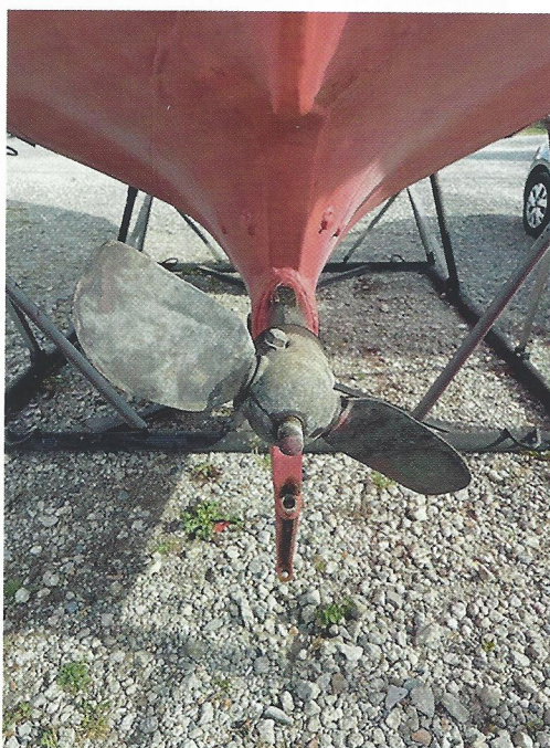
De vernuftige 2-blads schroef met keerbare bladen.
